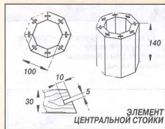
В нижнюю консоль ввинчивают шпильку и надевают на нее консоль первой ступени. На трубу центральной стойки накладывают вторую восьмигранник.
